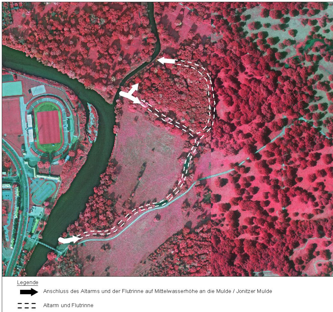
Abbildung 1: Maßnahmen zur hydraulische Aktivierung eines Altarmes der Jonitzer Mulde und einer Flutrinne
