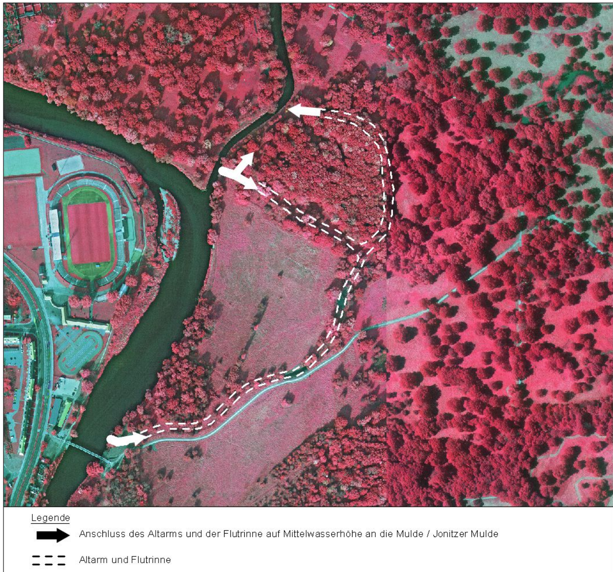
Abbildung 4: Maßnahmen zur hydraulische Aktivierung eines Altarmes der Jonitzer Mulde und einer Flutrinne
